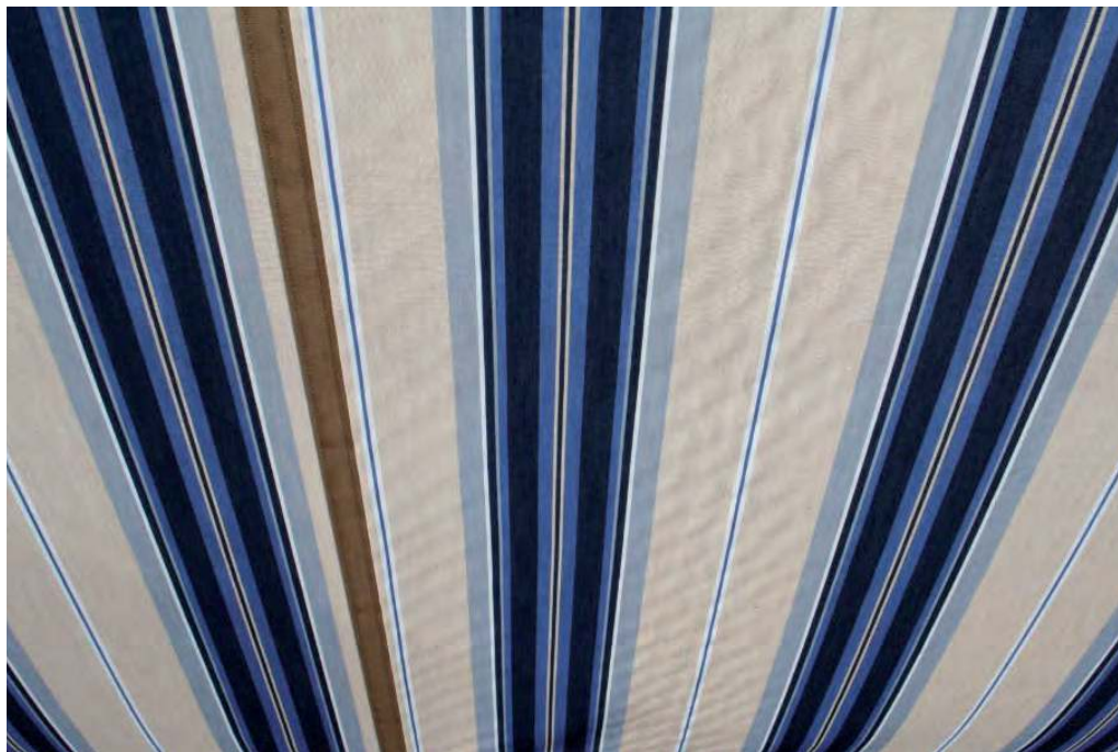
Bild 9.1.10 Zulässige Welligkeit im Bahnbereich (Wabenbildung)
